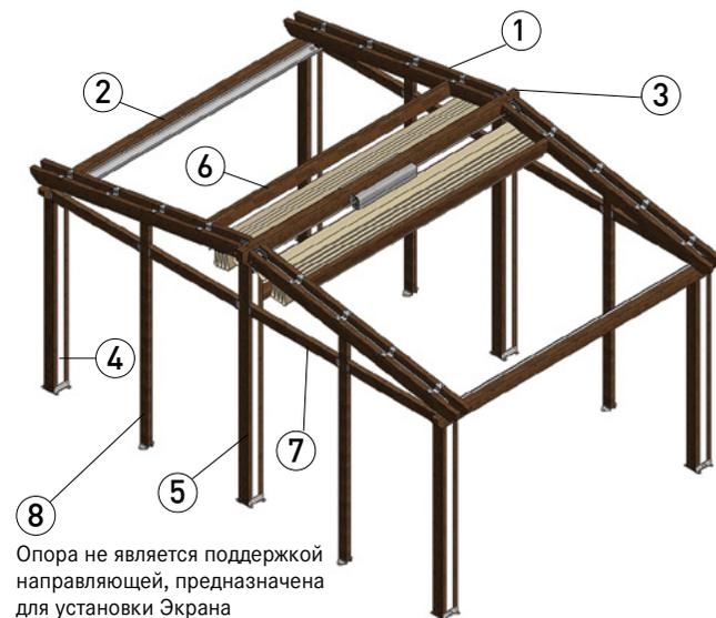
Опора не является поддержкой направляющей, предназначена для установки Экрана
